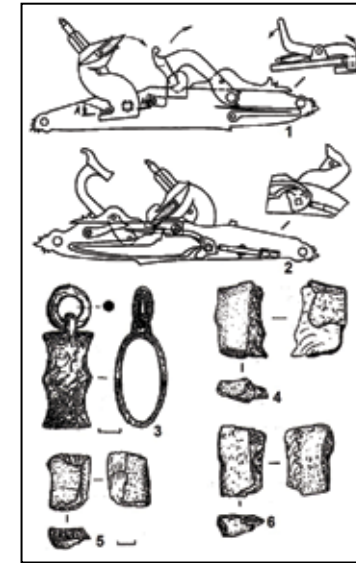
Рис. 3. Механізм дії кременінно-ударного замка «голландського» типу (1, 2) і предмети холодної (3) та ручної вогнепальної зброї (4-6) з Богородицької фортеці (1, 2 – за Л. Маяковською, 3-6 – за І. Ковальовою, В. Шалобудовим, В. Векленком).
